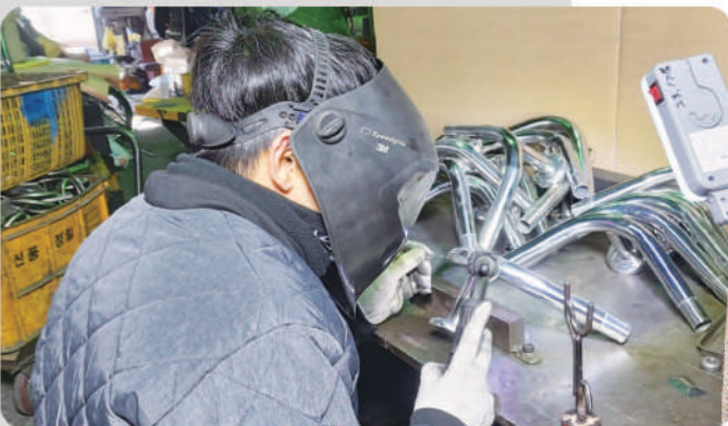
장애자 손잡이 알곤용접 작업
