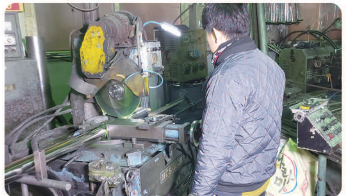
원형톱기계 손잡이 각도작업 및 원형 파이프 절단 작업
