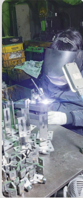
유리 난간대 알곤용접 작업
