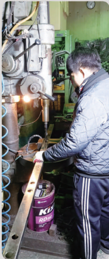
자전거 보관대 홀(구멍) 작업
