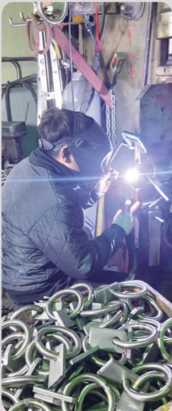
청소용 고리 알곤용접 작업
